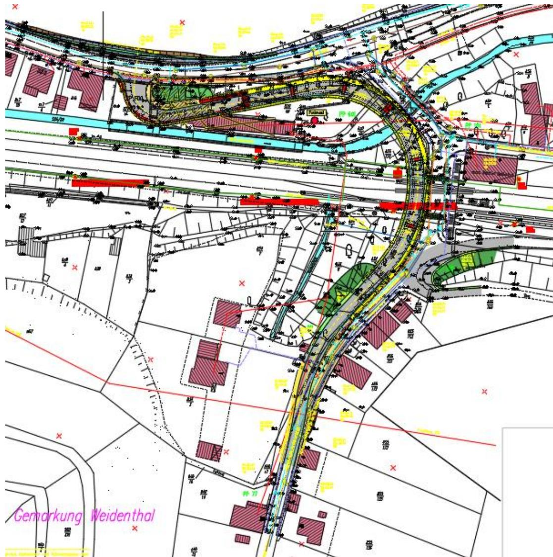
Die Variante 3 stellt die favorisierte Lösung dar. Dies begründet sich insbesondere aus dem Sachverhalt, dass bei dieser Variante der Bahnübergang während der kompletten Bauzeit offen gehalten werden kann, während bei den anderen Varianten nur eine halbseitige Offenhaltung des Bahnübergangs möglich ist, oder ein vorheriger Umbau desselben erforderlich ist. Zudem ist bei den ersten beiden Varianten auch der Flächenbedarf (anlage- und baubedingt) deutlich höher.
