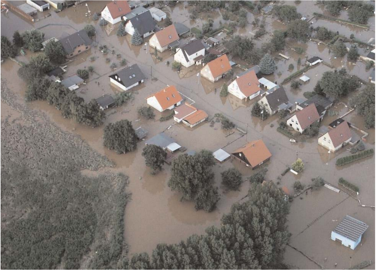
Abb. 10 Die Kombination aus Flussverbauung, Begradigung und Bodenversiegelung führt dazu, dass das Regenwasser nicht mehr zeitlich versetzt, sondern gleichzeitig in die großen Flüsse fließt: Hochwasserspitzen entstehen.
