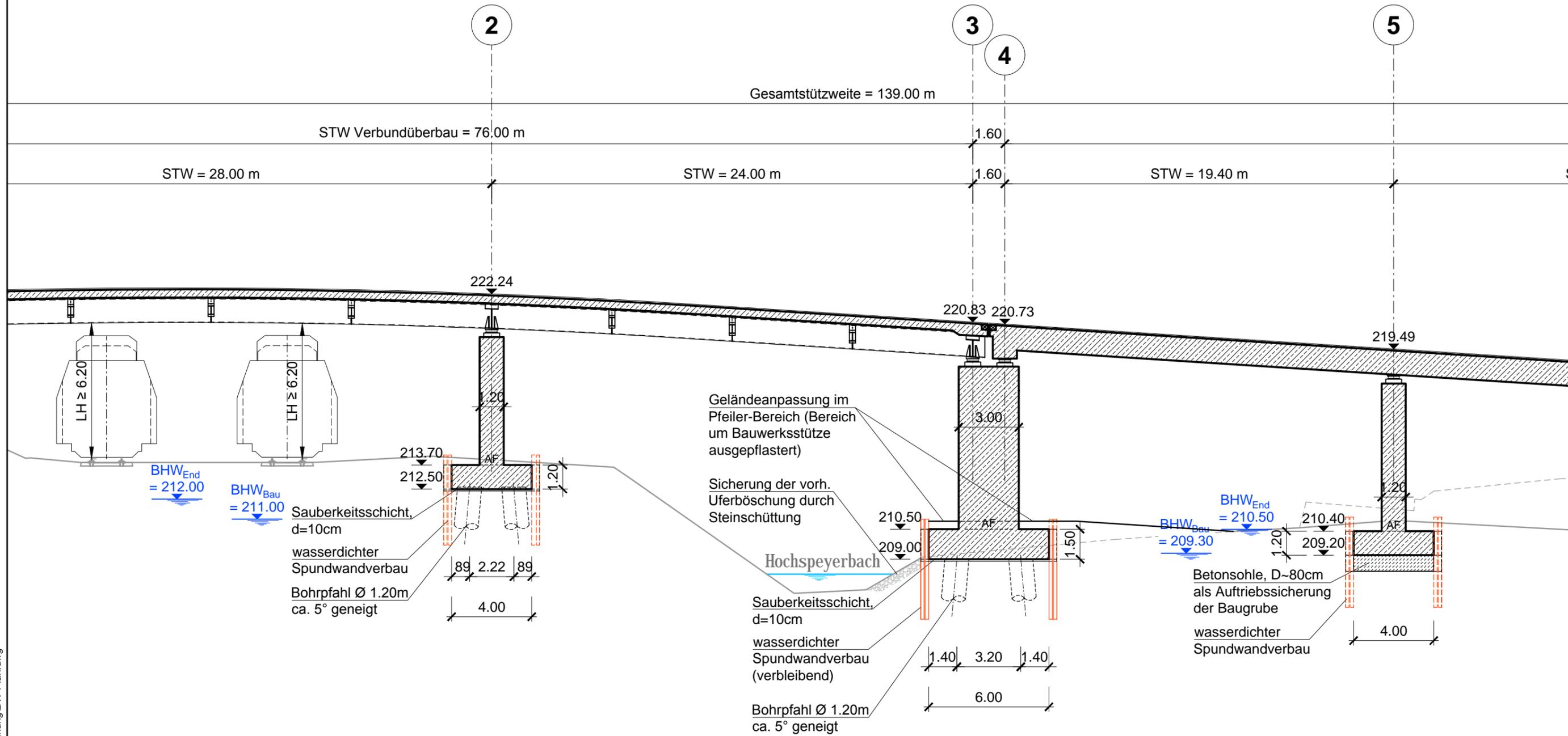
LÄNGSSCHNITT BEREICH PFEILER ACHSE 3 UND 4
