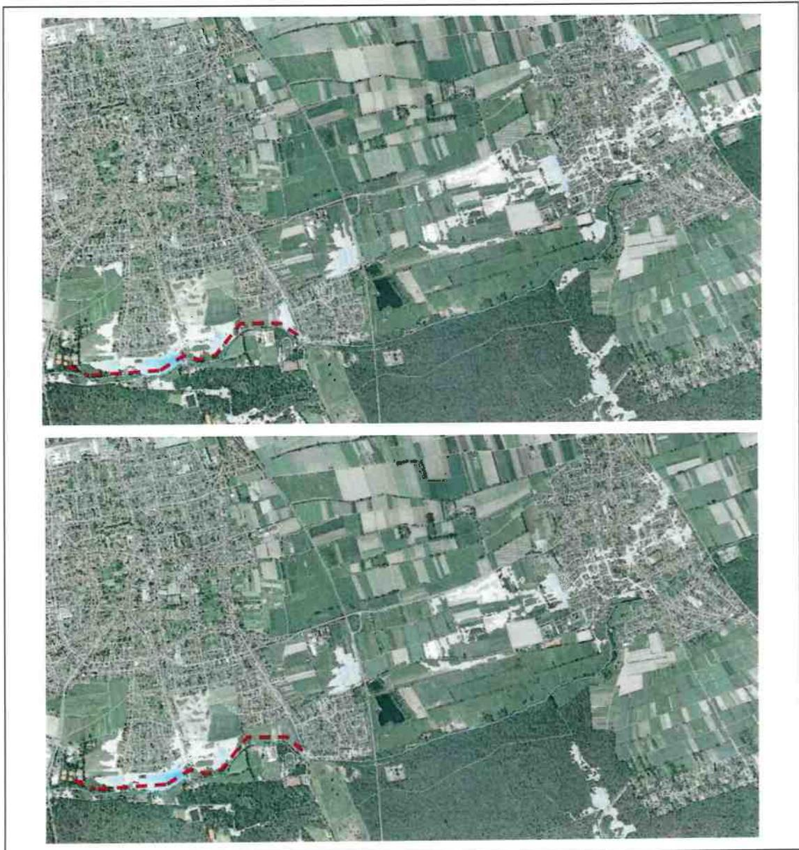
**Abbildung 3.7:** Ist-Zustand beim 20- (oben) und 10-jährlichen (unten) Hochwasser bei Versagen der Verwallungen/ Dämme zwischen Hubertushof und Neumühle (rote gestrichelte Linie). Die blau eingefärbten Bereiche stellen die Betroffenheit durch Hochwasser dar.
