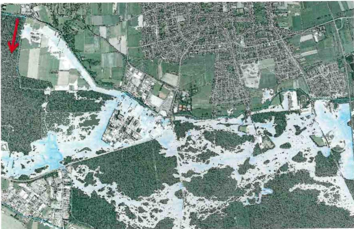
**Abbildung 3.17:** Konzept der Projektgegner: Anlage eines Flutgrabens zwischen Pfalzmühle und tief liegendem Bereich nördlich des Industriegebietes Lachen-Speyerdorf (Trassen 7, 3, 4) mit dem sich ergebenden Strömungsbild bei einem 100-jährlichen Hochwasser.
