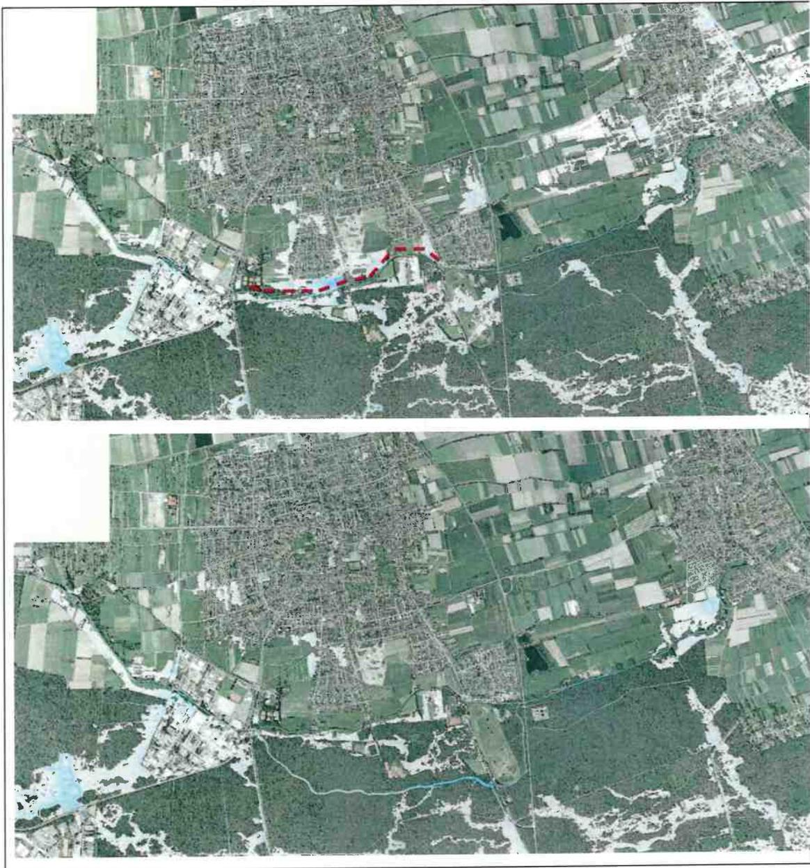
**Abbildung 3.10:** Überschwemmungsflächen beim 50-jährlichen Hochwasser ohne Rehbachverlegung mit Dammbriichen in den Bereichen Sägmühle und Neumühle (rote gestrichelte Linie) (oben) im Vergleich zur Wirkung der Rehbachverlegung (unten). Die blau eingefärbten Bereiche stellen die Betroffenheit durch Hochwasser dar.
