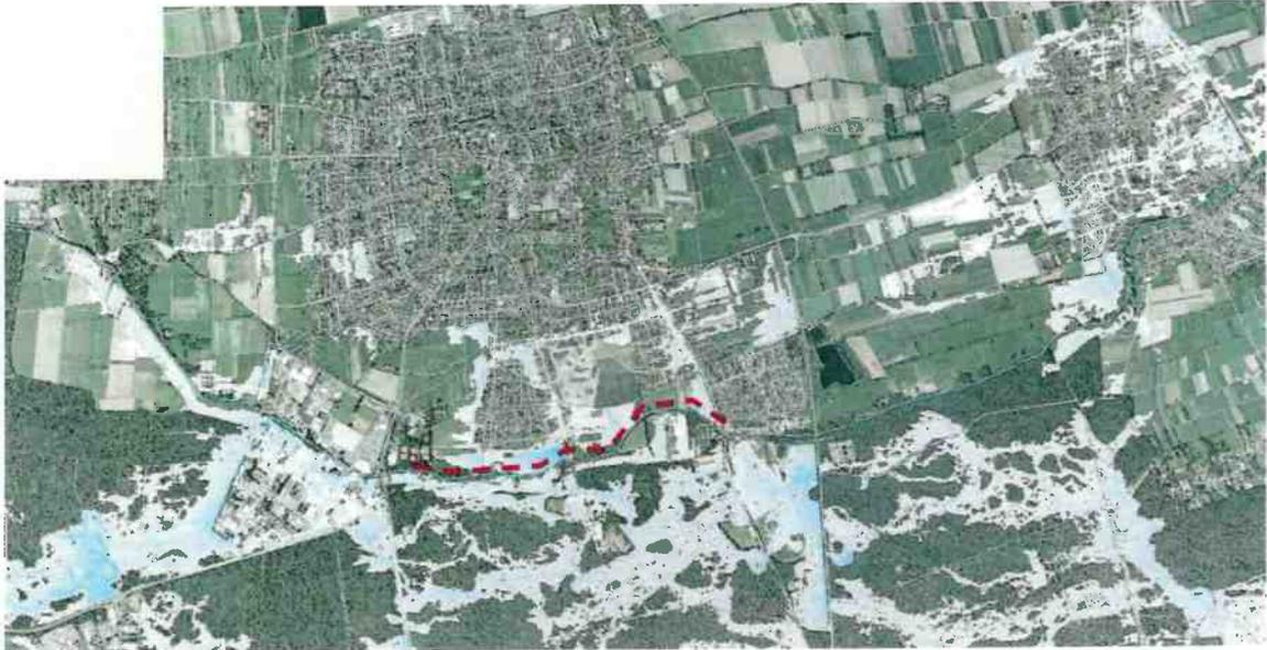
**Abbildung 3.5:** Ist-Zustand beim 100-jährlichen Hochwasser bei Versagen der Verwallungen/ Dämme zwischen Huberstushof und Neumühle (rote gestrichelte Linie). Die blau eingefärbten Bereiche stellen die Betroffenheit durch Hochwasser dar.
