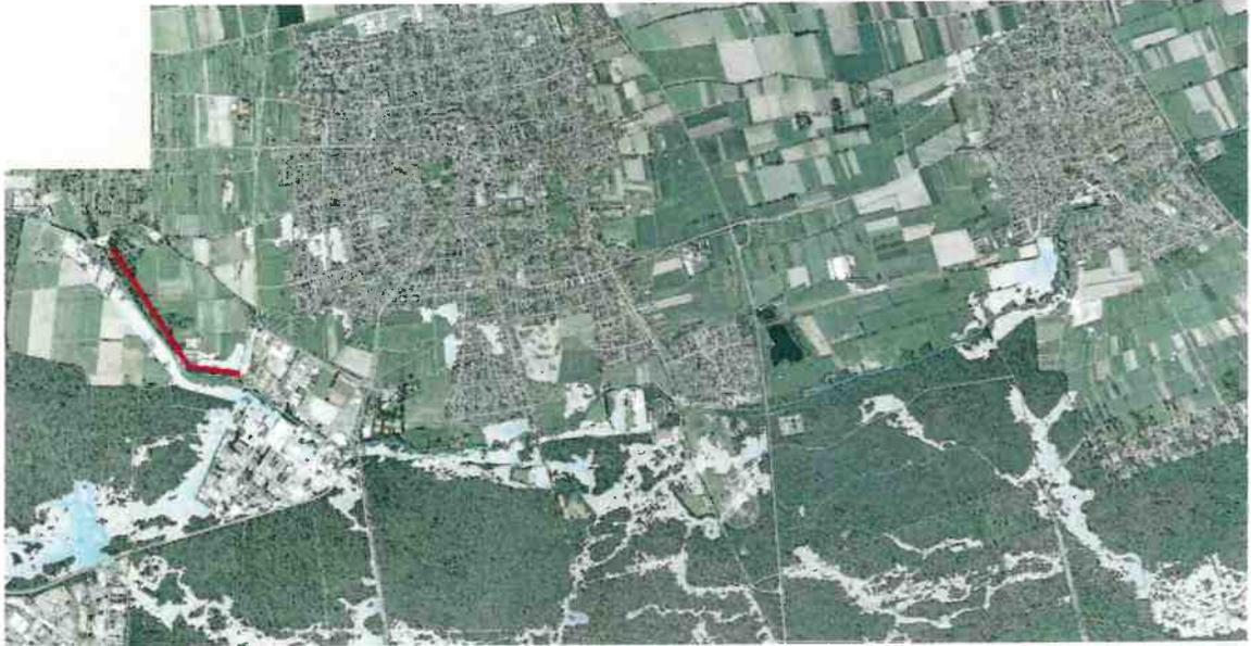
**Abbildung 3.2:** Ist-Zustand beim 50-jährlichen Hochwasser ohne Versagen der Verwallungen/Dämme zwischen Pfalzmühle und Obermühle (rote durchgezogene Linie). Die blau eingefärbten Bereiche stellen die Betroffenheit durch Hochwasser dar.
