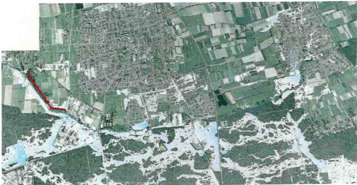
**Abbildung 3.1:** Ist-Zustand beim 100-jährlichen Hochwasser ohne Versagen der Verwallungen/Dämme zwischen Pfalz- und Obermühle (rote durchgezogene Linie). Die blau eingefärbten Bereiche stellen die Betroffenheit durch Hochwasser dar.
