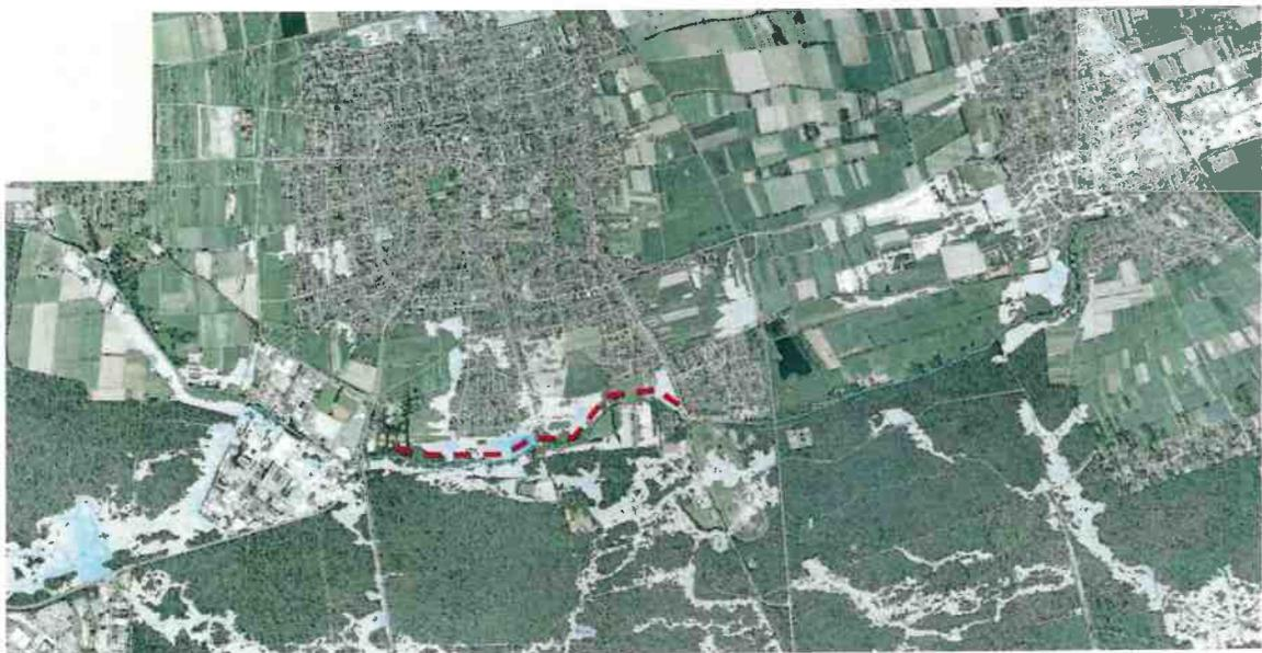
**Abbildung 3.6:** Ist-Zustand beim 50-jährlichen Hochwasser bei Versagen der Verwallungen/ Dämme zwischen Huberstushof und Neumühle (rote gestrichelte Linie). Die blau eingefärbten Bereiche stellen die Betroffenheit durch Hochwasser dar.
