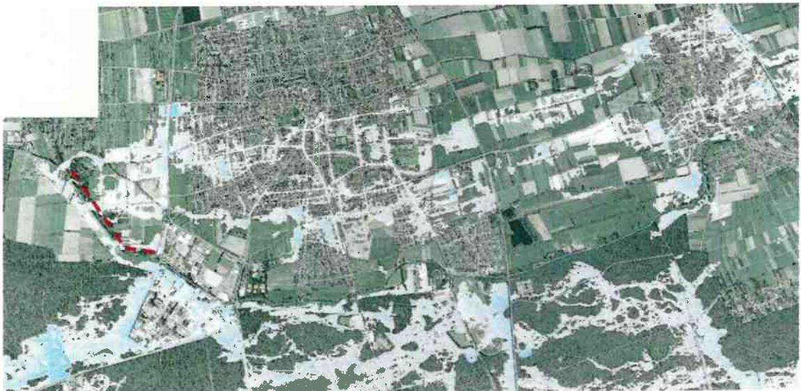
**Abbildung 3.3:** Ist-Zustand beim 100-jährlichen Hochwasser bei Versagen der Verwallungen/Dämme zwischen Pfalzmühle und Obermühle (rote gestrichelte Linie). Die blau eingefärbten Bereiche stellen die Betroffenheit durch Hochwasser dar.
