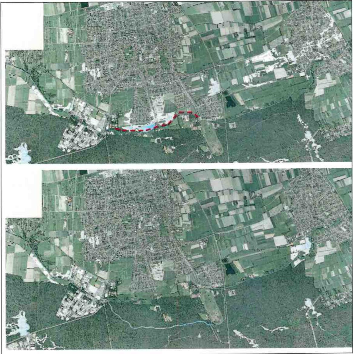
**Abbildung 3.12:** Überschwemmungsflächen beim 10-jährlichen Hochwasser ohne Rehbachverlegung mit Damnbrüchen in den Bereichen Sägmühle und Neumühle (rote gestrichelte Linie) (oben) im Vergleich zur Wirkung der Rehbachverlegung (unten). Die blau eingefärbten Bereiche stellen die Betroffenheit durch Hochwasser dar.
