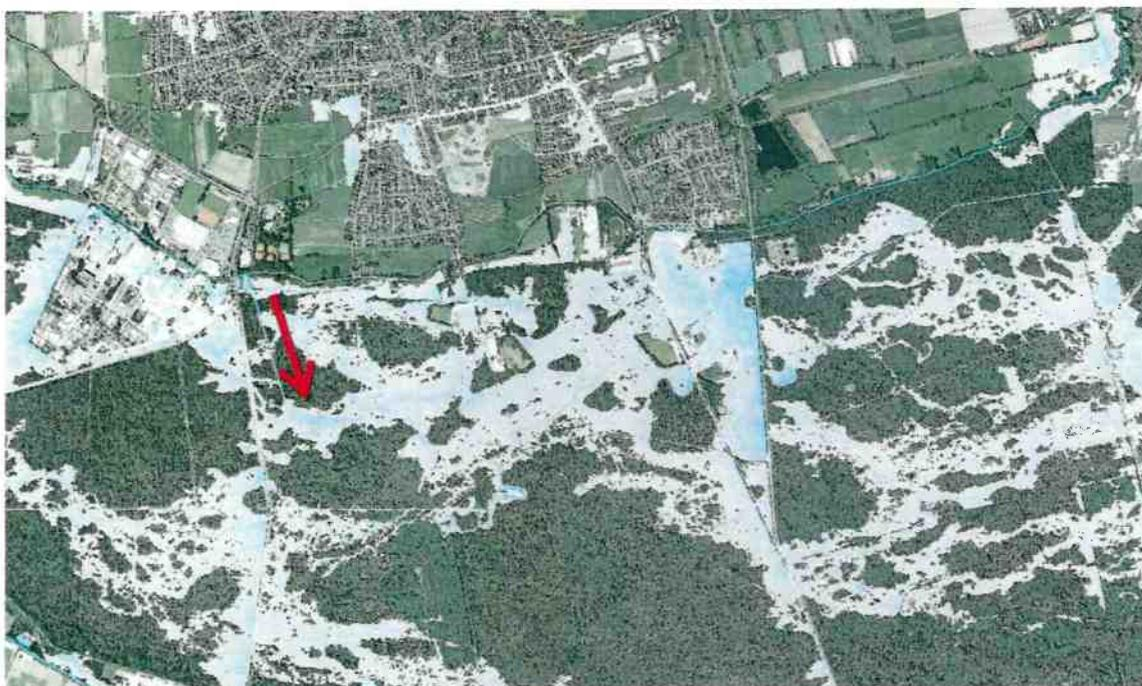
**Abbildung 3.19:** Konzept der Projektgegner: Anlage eines Flutgrabens unterhalb des Hubertushofes (sinngemäß Trasse 9) mit dem sich ergebenden Strömungsbild bei einem 100-jährlichen Hochwasser.
